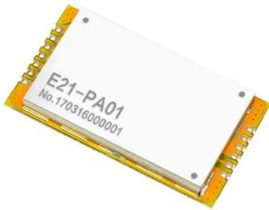
E21-PA01 是成都亿佰特公司推出的一款纯硬件射频中功率放大器 (PA)，最大输出功率 1W，覆盖频率范围 410 ~ 480MHz，模块内置 LNA 低噪声放大器，大幅度提高了无线之间的通信距离。
