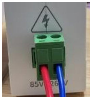
NA111-A 电源接线(AC 85~265V, L (火线, 红色), N (零线, 蓝色)):
