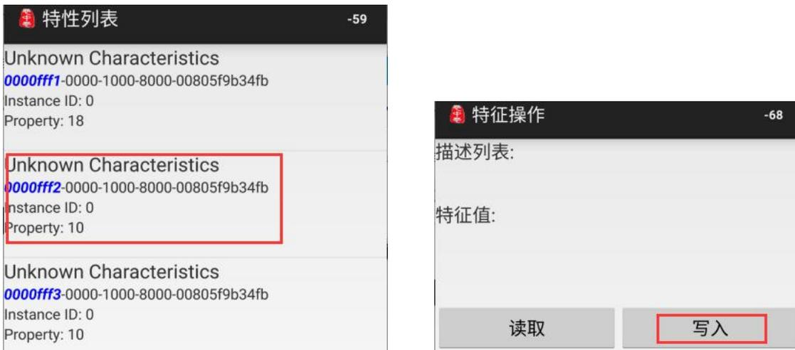
7、填写并发送数据“12345678901234567890”，模块 E104-BT02 将收到的数据通过串口透传输出。
