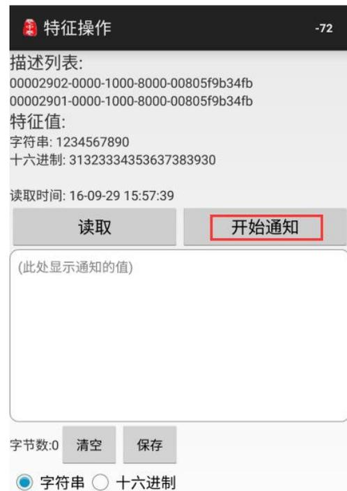
5、使用串口调试助手，通过模块 E104-BT02 发送字符串“1234567890”（模块工作在唤醒透传模式），APP 提示接收到字符串。
