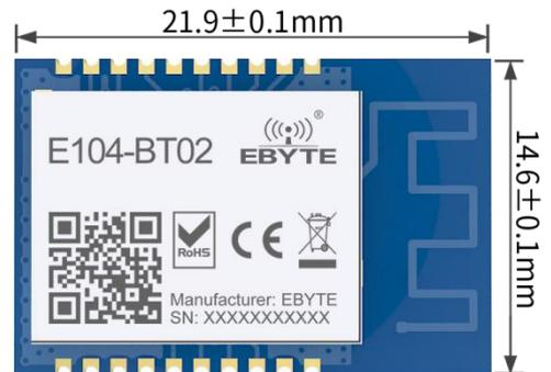
E104-BT02 模块支持 BluetoothV4.2 标准，简单配置后可与符合蓝牙 4.2 协议的主机建立蓝牙连接，实现串口数据透传。模块支持主从角色配置，支持主从模块点对点连接实现数据快速透传功能，最大限度减少开发者的工作和项目开发时间。
