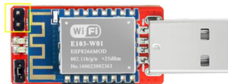
拔GPIO0上的跳线帽
