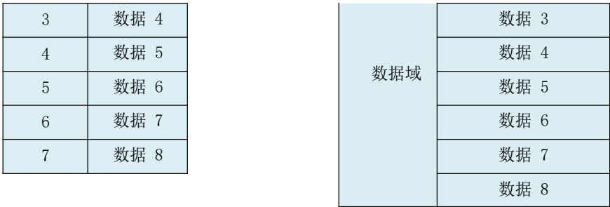
串行帧转换成 CAN 报文（透明方式）
