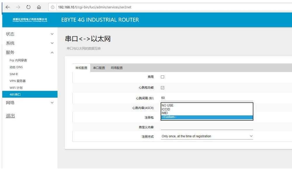
上图所示中，常规配置选项具备使能串口服务，以及使能心跳包的相关服务，这里我们默认都是没有打开的，但如果用户启用了串口服务，为了防止链接中断我们建议用户同时将心跳包功能开启，注册包中，可以选择注册方式，这里我们提供了SIM卡的 ICCID 以及 IMEI 作为注册包，当然用户也可以自定义注册包内容或者注册方式，另外需要说明的是注册包与心跳包内容。
