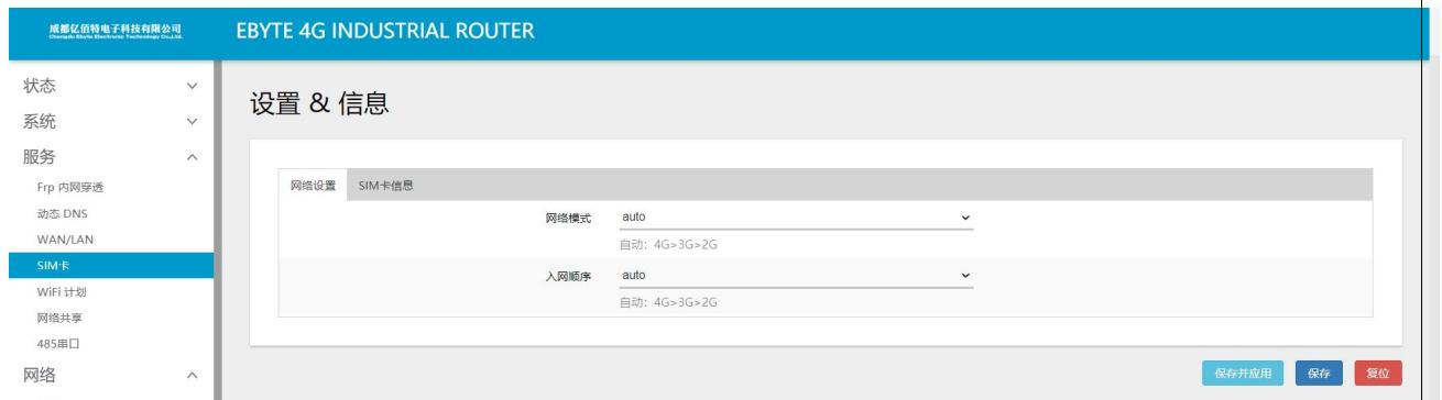
LTE mode 是锁网模式，客户可通过该选项切换当前的网络属性 (4G/3G/2G)，这里，需要说明的是，客户在切换网络时，一定要事先知晓当前电信提供商是否具备所设置的网段，例如，客户 A 使用的移动的 4G 卡，它将 LTE mode 设为 3G，出现的结果没有该服务（信号质量指示灯全部熄灭）。原因是移动卡已经撤了 3G 的网段，路由器无法搜索到相应的服务。
