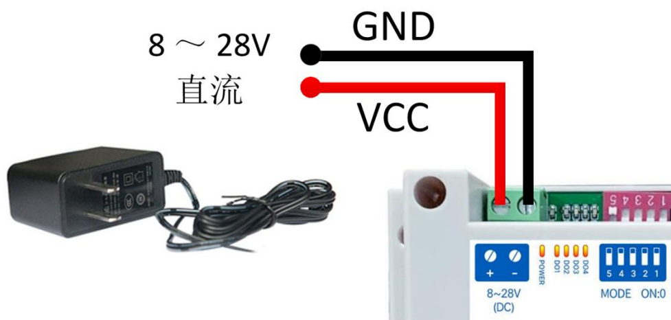
图 2-2-1 电源接线图
