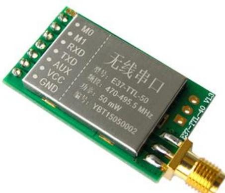
E37-TTL-50 是一款基于 AX5043 射频芯片的 433M 直插型无线串口模块 (UART)，半双工，收发一体，透明传输方式，发射功率 50mW，工作在 470~495.5MHz 抄表频段（默认 490MHz），TTL 电平输出，兼容 3.3V 与 5V 的 IO 口电压，具有空中唤醒功能（超低功耗）。
