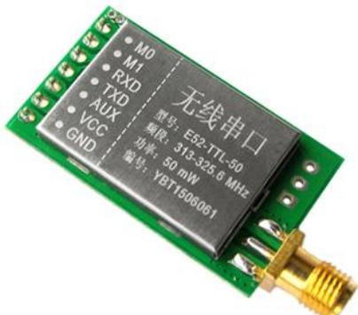
E52-TTL-50 是一款基于 AX5043 射频芯片的 315M 直插型无线串口模块（UART），半双工，收发一体，透明传输方式，发射功率 50mW，工作在 313~325.6MHz 遥控频段（默认 315MHz），TTL 电平输出，兼容 3.3V 与 5V 的 IO 口电压，具有空中唤醒功能（超低功耗）。
